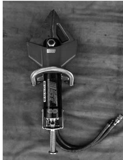
写真5 大型油圧切断機
