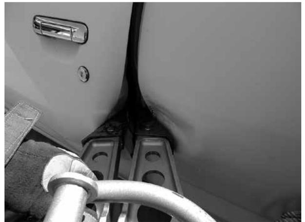
写真12 拡張してできたすき間にさらに挿入し拡張
