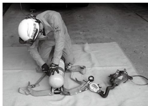
写真5 ボンベ締め付けバンドでボンベを固定
