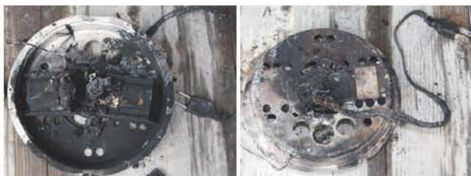
写真9 金属製上蓋の内側 (左) と外側の焼き状況 (右)
