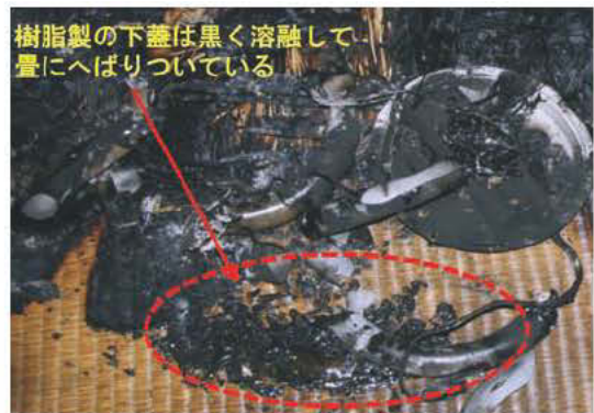
写真6 照明器具の焼き状況
