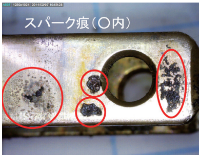
写真7 プラグ刃表面のスパーク痕
