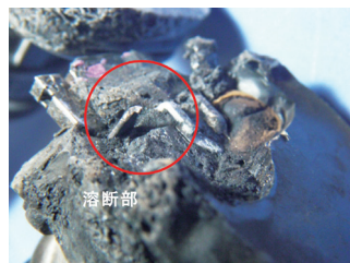
写真11 コイル3の溶解部
