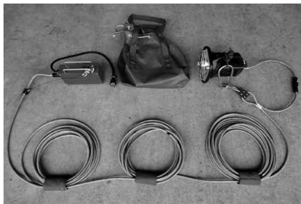
写真8 ケーブル10 mごとに印を付ける (進入隊員が何m進入したかの目安になる)
