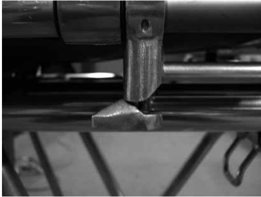
写真7 ポジションロックレバーを180度回転しロックを解除すると
