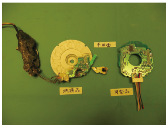
写真7 焼損した基盤（左）と同型品
