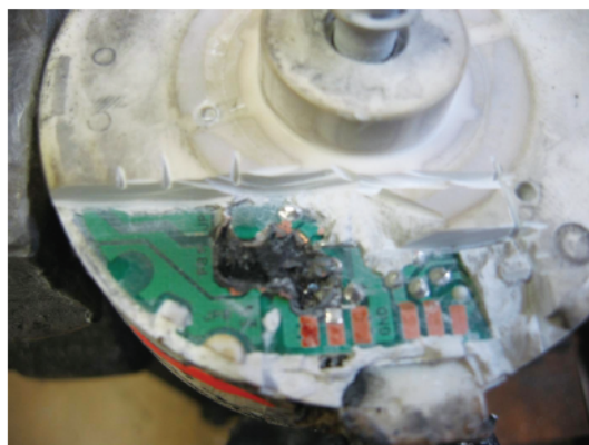
写真6 モーターを切り取り焼失箇所を特定
