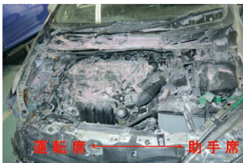
写真6 り災車両のエンジンルーム内
