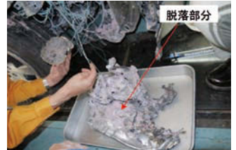
写真10 前照灯、前照灯周辺部の脱落部分
