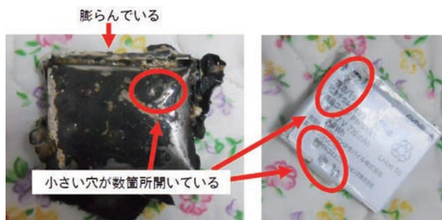
写真2 焼損した電池パック (左) と 焼損していない電池パック (右)
