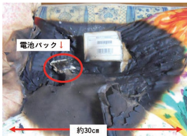
写真1 電池パックと布団類の焼損状況
