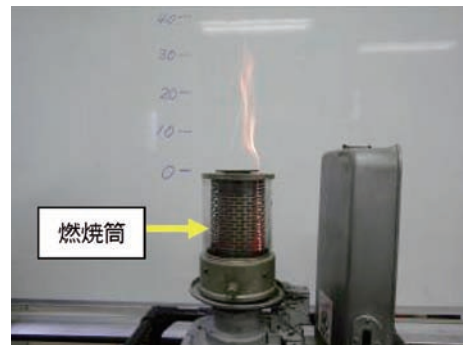
写真7 異常燃焼の状況
