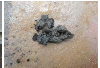
写真20 脱脂綿の焼損状況
