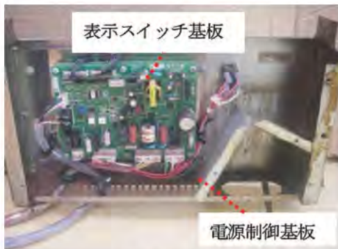
フライヤー基板
