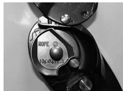
写真22 I'Dの内部には誤設定防止に記号が書いてあります。これを参考にして荷重側の端末を下から通していきます。
