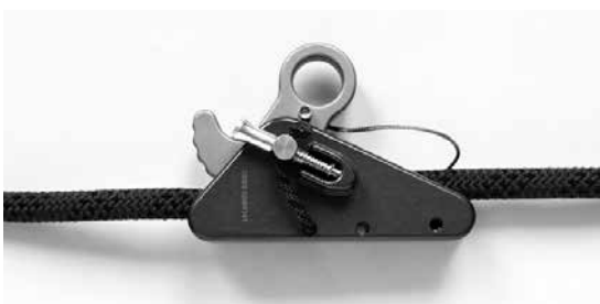
写真25 過重方向に力が加かるようにロープを巻き付けカバーをします
