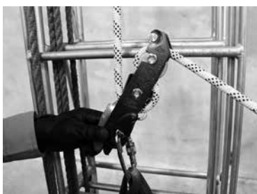
写真18 ロープがS字になっていれば設定完了です。
