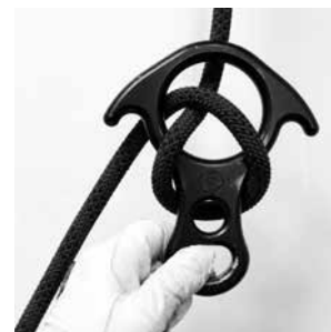
写真15 ロープがしっかり噛んだら固定完了です
