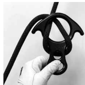
写真14 固定方法です。下側のロープを上側のロープにかけます
