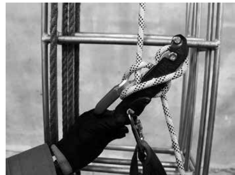
写真20 ロープを本体の上から通してカラビナに通します
