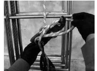
写真20 ロープを本体の上から通してカラビナに通します
