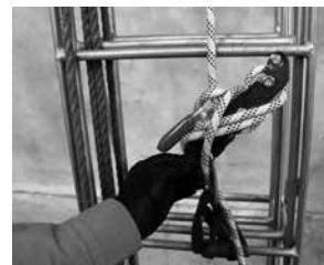
写真21 ロープをひねって本体に巻き付けて固定完了です
