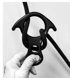
写真13 懸垂降下のイメージです。下側のロープを操作して制動を取ります
