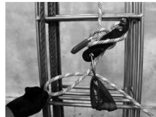
写真20 ロープを本体の上から通してカラビナに通します
